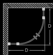
Профили всех душевых кабин изготавливаются из алюминия и покрываются никелем. На все неподвижные панели устанавливается стекло толщиной 8мм с защитным покрытием 3M™, облегчающим чистку стекла от известкового налета.
