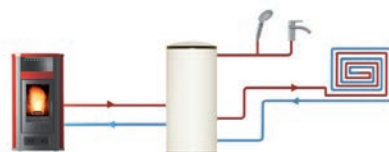
Riscaldamento a pavimento Underfloor heating
