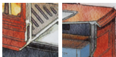
Слева: для увеличения герметичности при закрытой створке дверцы, согласно точному расчету, вторая створка плотно входит в паз с помощью фибerglassового шнура.
